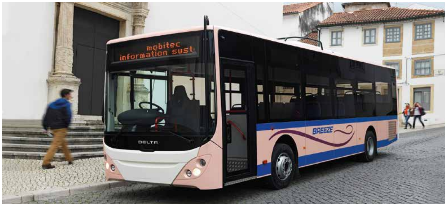
Der belgische Bushersteller „Mercury Trading“ setzt LAMILUX Composites in segmentierter Bauweise in den Seitenwänden ein. The Belgian bus manufacturer „Mercury Trading“ uses LAMILUX composites in segmented designs in the side walls.
